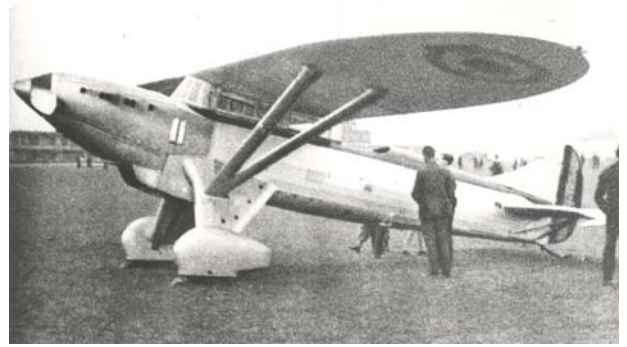
Toujours à Haren, probablement en 1936, le R-32 motorisé avec un Hispano-Suiza 12 Ybrs et hélice bipale à pas fixe peu avant son crash fatal. (Musée Royal de l'Armée)
