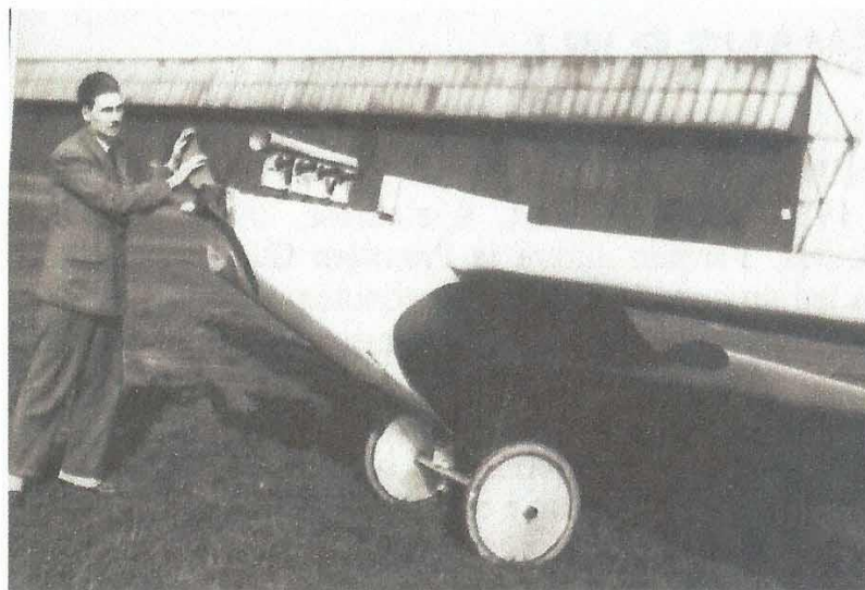
Le concepteur et constructeur du RWI, Robert Wielemans, simulant un lancer d'hélice, avec gros plan sur le moteur Sergant de quatre cylindres en ligne. (Archives JP Decock)
