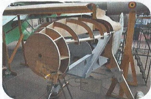
**Fabrication et montage des couples destinés à recevoir les capots moteur de l'avion**
