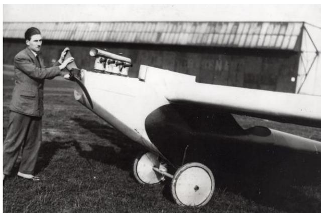
Le concepteur et constructeur du R.W. I, Robert Wielemans, simulait un lancer d'hélice, avec gras plan sur le moteur Sergeant de quatre cylindres en ligne. (Archives JP Decock)
