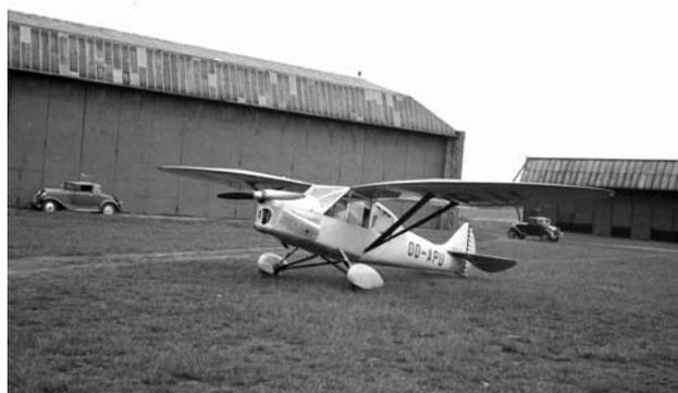
L'appareil est muni de double commandes côte à côte. La cabine se caractérise par sa clarté et sa remarquable visibilité, obtenues par l'emploi de grands panneaux de cellon. Au repos, les ailes peuvent être repliées vers l'arrière.
