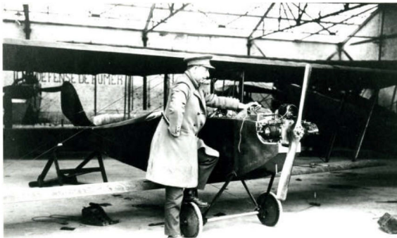
L'aviette Fabry vue ici, dans un hangar peut-être à Bruxelles avec le bicylindre Anzani de l'aviette Daumerie.
