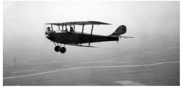
L'aviette Fabry, non encore immatriculée vue ici en vol probablement au-dessus de Wevelgem. On remarque sa dérive arrondie et fortement déportée vers l'arrière.
