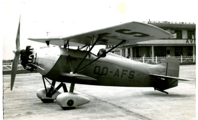
Le Mulot AGMA 75HP OO-AFS à moteur Popjoy On remarque la particularité du moteur qui a son axe d'hélice décalé vers le haut.
