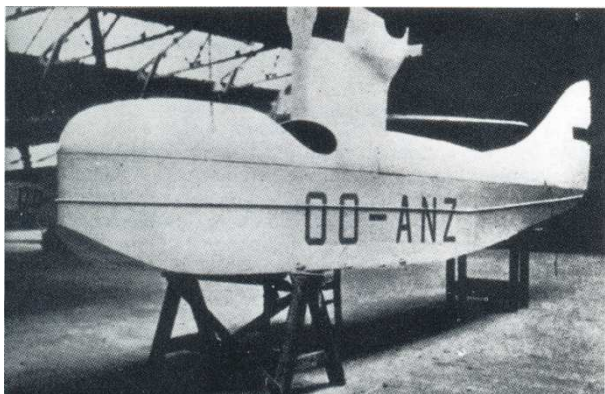
Le fuselage du S.B.O. en cours de construction à Saint-Hubert fin 1934 ou début 1935. Remarquez le bâti-moteur profilé.
