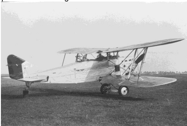
Version militaire de l'ACAZ C-2 présenté à l'aéronautique militaire. On peut remarquer les irrégularités du recouvrement en aluminium. (Photo coll. G. Lecomte)
